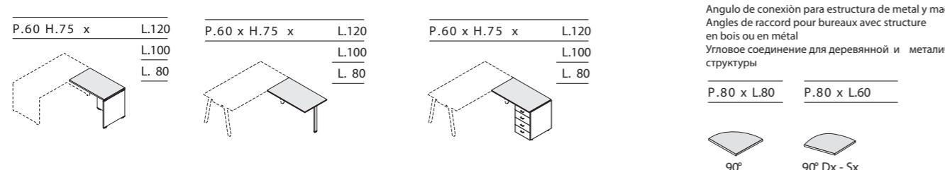
**Angoli di raccordo per struttura legno e metallica**
